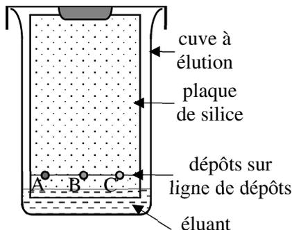
Schéma d'un chromatogramme obtenu :
