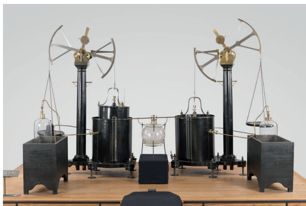
Figure 3 : Les gazomètres de Lavoisier. © Cnam – Musée des Arts et Métiers. Photo Franck Botté.
