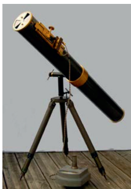
Figure 3 : Télescope pyrhéliométrique de Charles Féry, construit par la maison Beaudouin vers 1905, retrouvé par la Commission Patrimoine de l'ESPCI en 2018 et reconstitué par Bernard Pigelet et la Société astronomique de France (Crédits A. Legrand).
